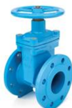
Задвижки чугунные с обрешиненным клином Ру 1,0 - 1,6 МПа, Ду 50 - 800 мм.,
