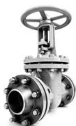
Задвижки стальные клиновые литые Ру 1,6 — 25,0 МПа, Ду 50 — 1200 мм., Сталь 25Л, 20ГЛ, 12Х18Н9ТЛ, 12Х18Н12МЗТЛ, 20Х5МЛ, 20ГМЛ
