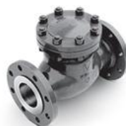
Затворы (клапаны) обратные поворотные стальные Ру 1,6 — 16,0 МПа, Ду 50 — 1000 мм., Сталь 25Л, 20ГЛ, 12Х18Н9ТЛ
