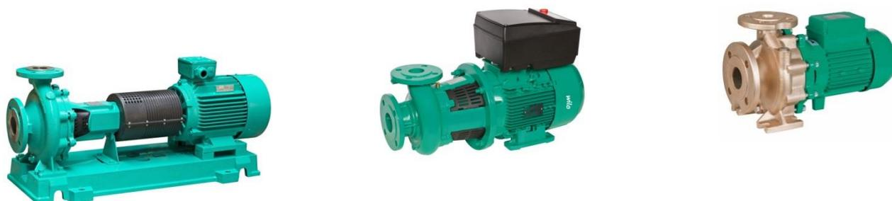
Одноступенчатый центробежный насос NL на общей раме с мотором, соединенный с ним разборной муфтой или в виде моноблока VL. Материал проточной части: чугун, бронза или нержавеющая сталь. Диаметр колеса подрезается по рабочей точке. Мотор класса IE2 с термодатчиками. Уплотнение торцовое, возможен сальник. Рабочая температура 120 °С (исполнение до 140°С).
