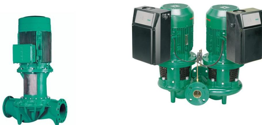
Одноступенчатый центробежный насос IL или сдвоенный DL в виде моноблока. Материал проточной части: чугун с катафорезным покрытием. Мотор класса IE2 с термодатчиками.
