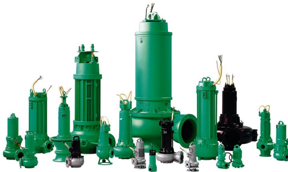
Насосы FA с мотором IP68 погружной и сухой установки. Расположение – вертикальное и горизонтальное. При затоплении работоспособность сохраняется, есть лючек прочистки проточной части, кольца щелевого уплотнения - сменные. Имеется промежуточная камера с экологически безопасным маслом. Камера отделена двойным торцовым уплотнением из карбида кремния.
