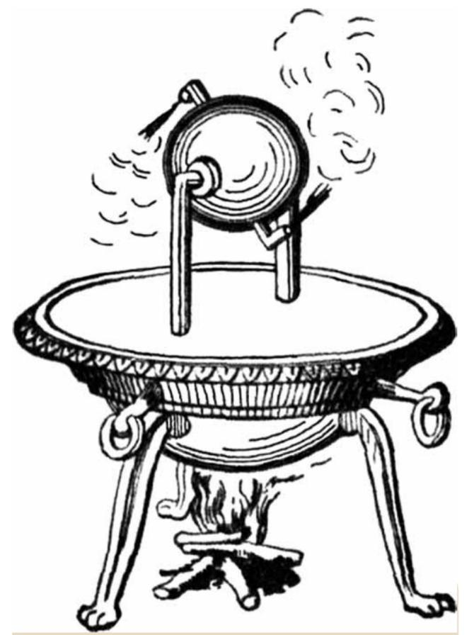
Паровой двигатель Герона
